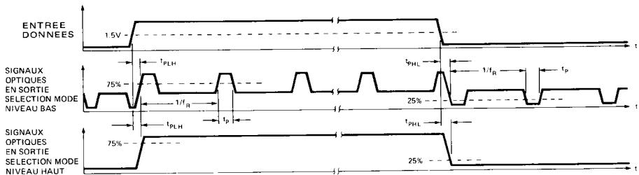
Figure 1— Codage du flux lumineux et diagramme de synchronisation
