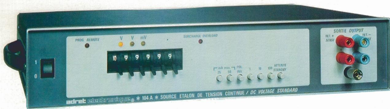
Le fonctionnement du 104 fait appel à un principe original de conversion Temps/amplitude, entièrement électronique, breveté par la Société et déjà utilisé sur le modèle 102.
