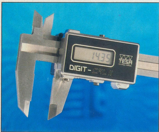
Pour la lecture, la firme suisse Tesa a choisi le procédé opto-électronique. La précision est comparable à celle du système capacitif, mais l'encombrement dû aux piles est plus important.
